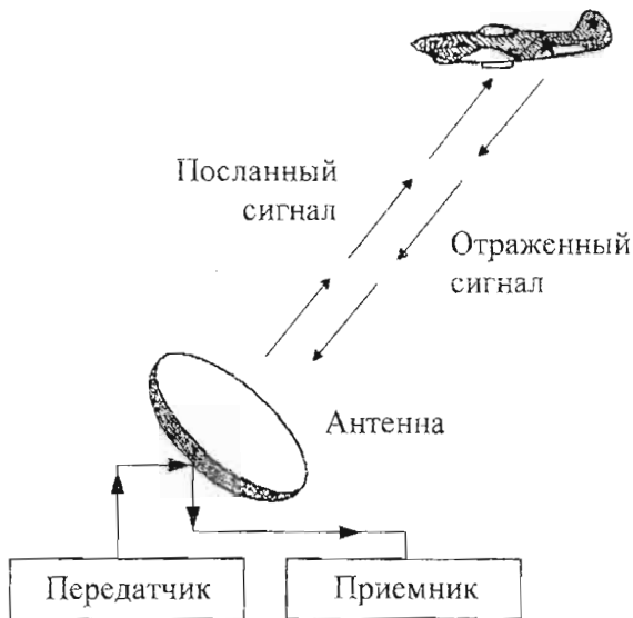
Схема радиолокационной системы
