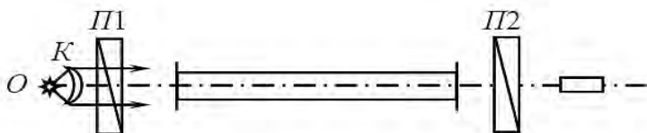
Рис. 3.20. Устройство сахариметра
