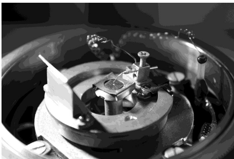
Рис. 19. Зазор между иглой и образцом
