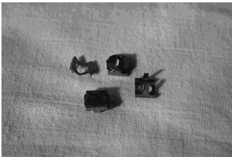
Рис. 15. Крепление СТМ-образца пружинкой (вид сверху и снизу), пружинка (вид сверху и снизу)
