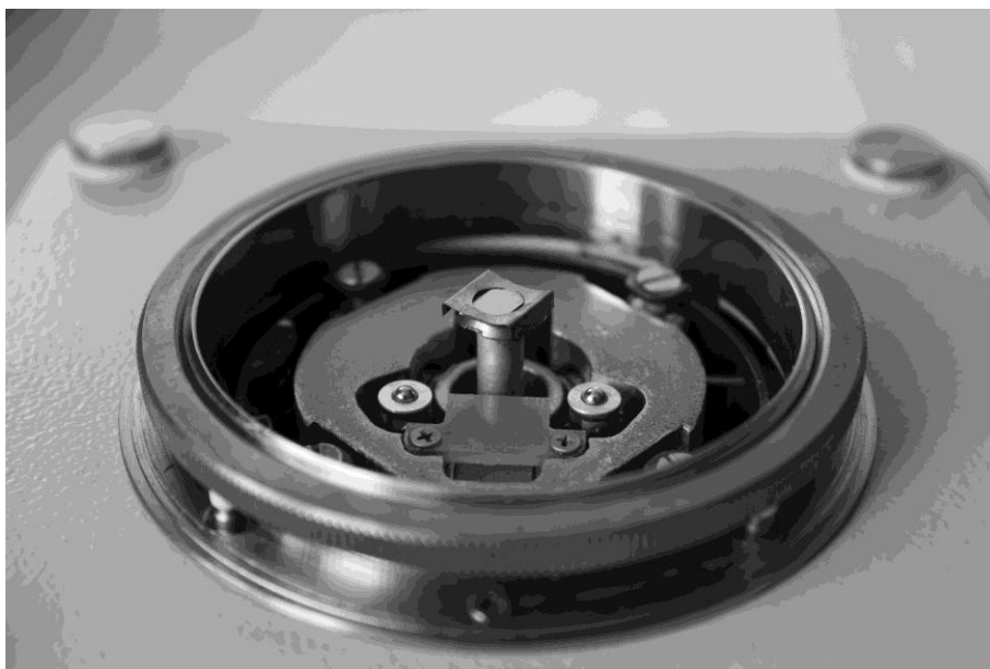
Рис. 16. Установленный СТМ-образец, без СТМ-столика
