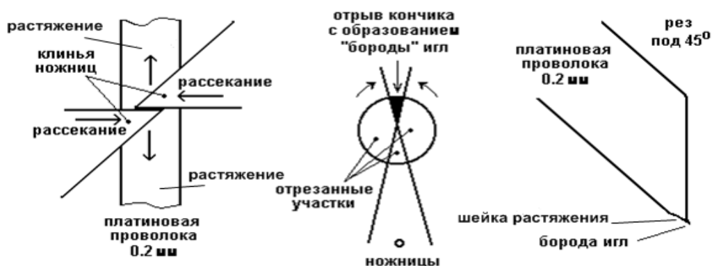
Рис. 18. Процесс рассекания – растяжения при обрезании иглы
