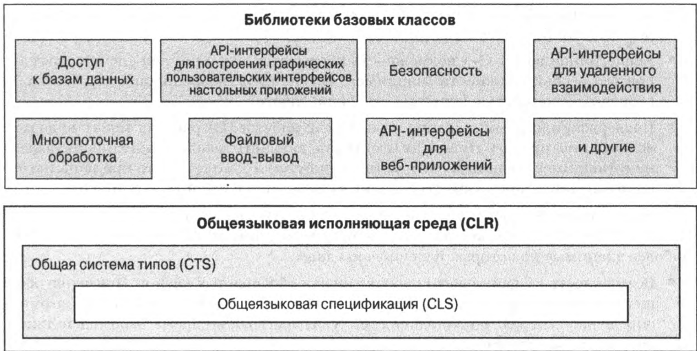
Рис. 1.1. Отношения между CLR, CTS, CLS и библиотеками базовых классов
