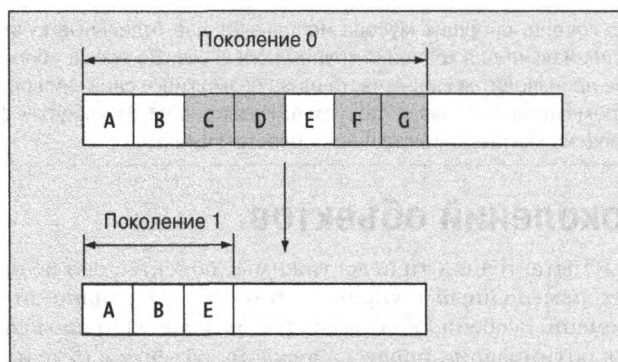
Рис. 13.5. Объекты поколения 0, которые уцелели после сборки мусора, повышаются до поколения 1
