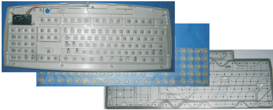
Рис. 13. Элементы резиноmemбранной клавиатуры
