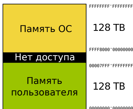
Рис. 24. Карта памяти процесса. В верхней части располагается код и данные ОС, в нижней код и данные процесса. Нижняя часть называется пользовательской, так как эта память отведена «пользователям» ОС — процессам. Пример изображен для архитектуры x64. В середине есть неотображенная на реальную память область адресов, так как архитектура x64 пока реализуется в компьютерах в усеченном виде, где есть ограничение по памяти 256 терабайт (ТБ): 128 для ОС и 128 для процесса. Адреса крайних страниц в памяти ОС и пользовательской (например, 00007FFF'FFFFFFFF) написаны в шестнадцатеричной системе счисления с разделением на группы по 8 цифр (символов)
