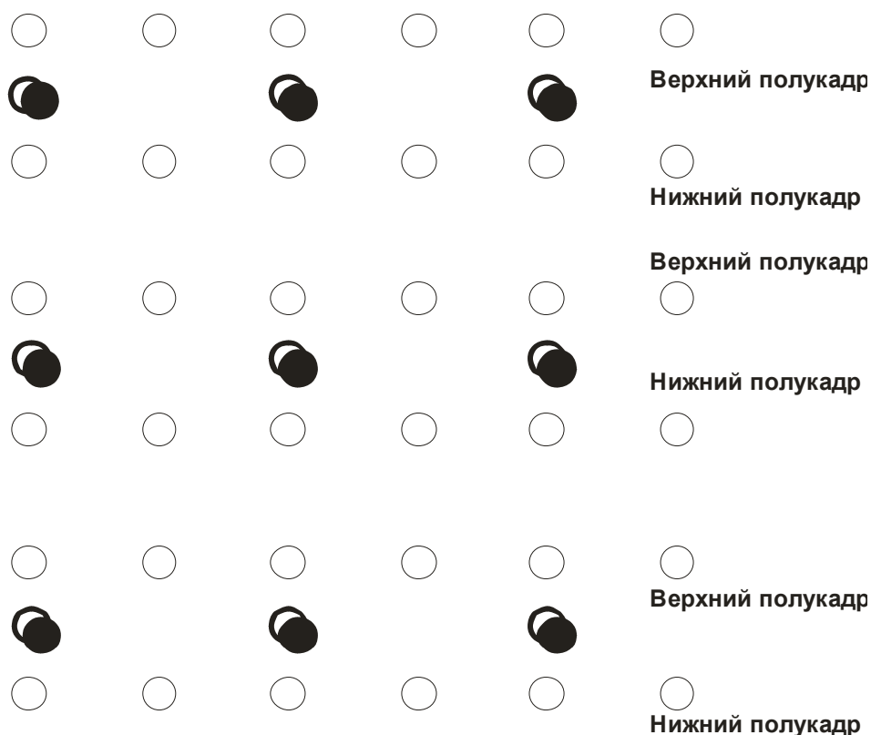
Рис. 5.7. Распределение сэмплов 4:2:0 между верхним и нижним кадрами
