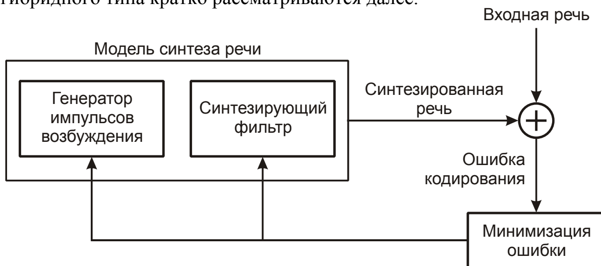
Рис. 8.1. Упрощенная схема кодера, использующего схему анализ-через-синтез
