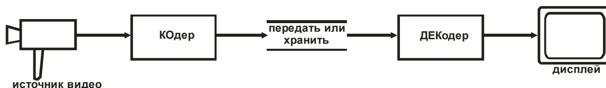
Рис. 6.1. Кодер / декодер
