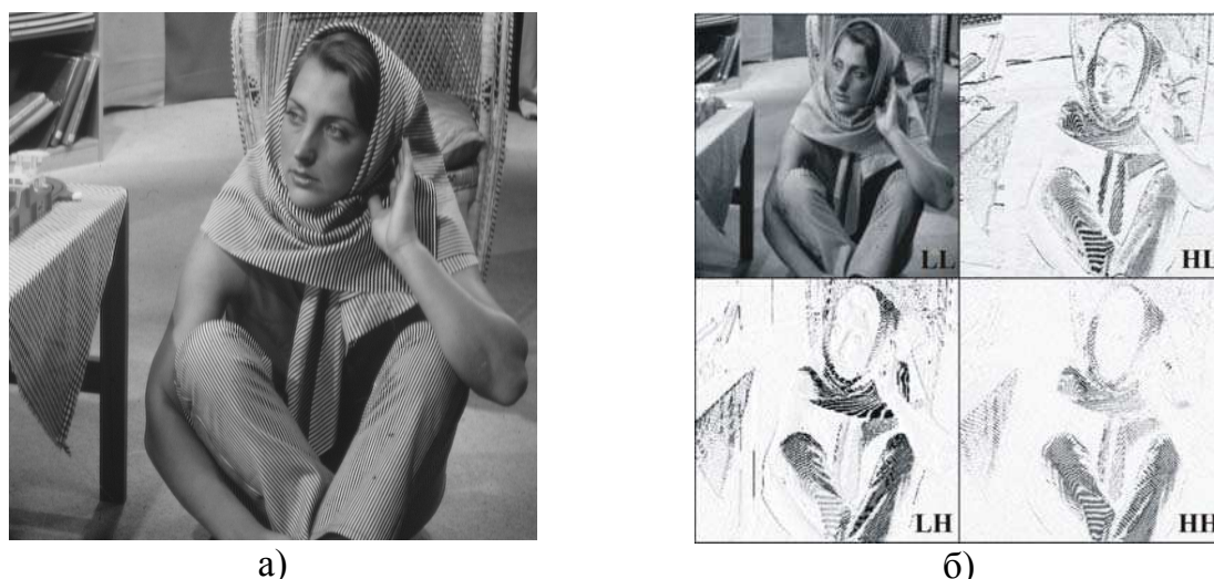
Рис. 1.6. а) Тестовое изображение Barbara; б) одноуровневая вейвлет-декомпозиция тестового изображения, где LL – выделенная низкая частота по горизонтали и низкая по вертикали, LH – низкая по горизонтали и высокая по вертикали, HL – высокая по горизонтали и низкая по вертикали, HH – высокая по горизонтали и по вертикали
