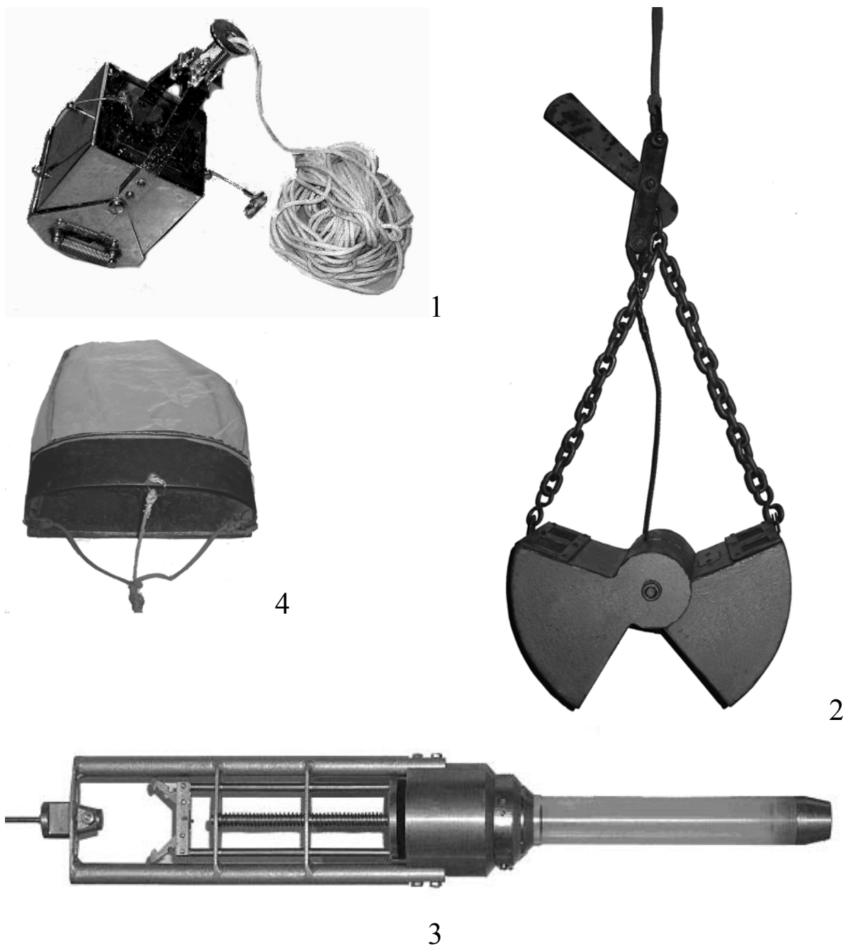
Рис. 3. Оборудование для отбора качественных и количественных проб бентоса: 1. Коробчатый дночерпатель Экмана-Берджа. 2. Ковшовый дночерпатель Петерсена. 3. Стратометр С-1. 4. Драга Дорогостайского
